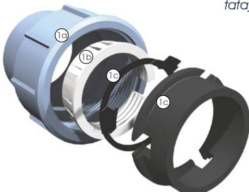
Per i raccordi di diametro 75, 90 e 110mm è stato sviluppato il sistema **DELT-ONE** nel quale la ghiera, l'anello di graffaggio e la bussola sono uniti a formare un unico componente. La guarnizione utilizzata è sempre di tipo O-Ring come nel modello classico.
